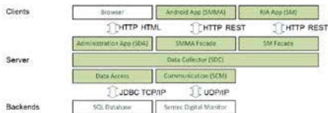
Abbildung 3: Software Architektur mit den wichtigsten Modulen. Der SenTec Digital Monitor (SDM) wird hier nur als Datenquelle betrachtet, obwohl das Gerät seine eigene Benutzerschnittstelle besitzt.
