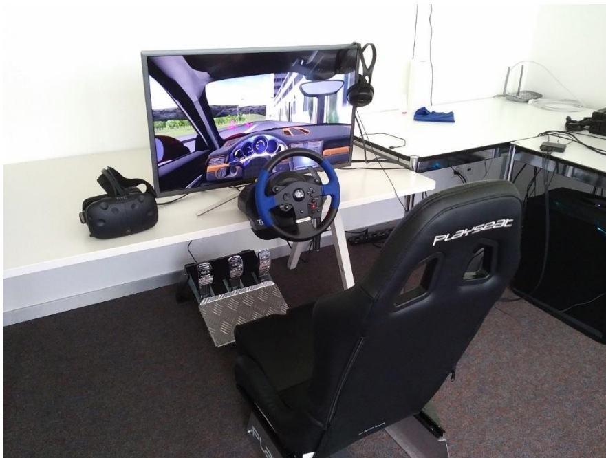
Abbildung 12: Eingerichteter Simulator mit Sitz, Lenkrad, Pedalen, Bildschirm, Kopfhörern und VR-Brille (eigene Darstellung)
