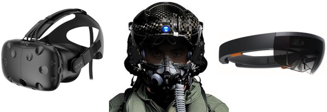
Abbildung 2: Beispiele für Head-Mounted Displays. HTC Vive (links), F-35 Gen III HMD (Mitte), Microsoft HoloLens (rechts)
