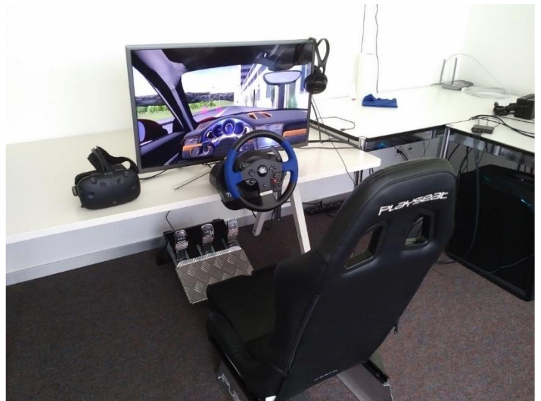
Abbildung 9: Eingerichteter Simulator mit Sitz, Lenkrad, Pedalen, Bildschirm, Kopfhörern, statischem Display und HMD (eigene Darstellung)
