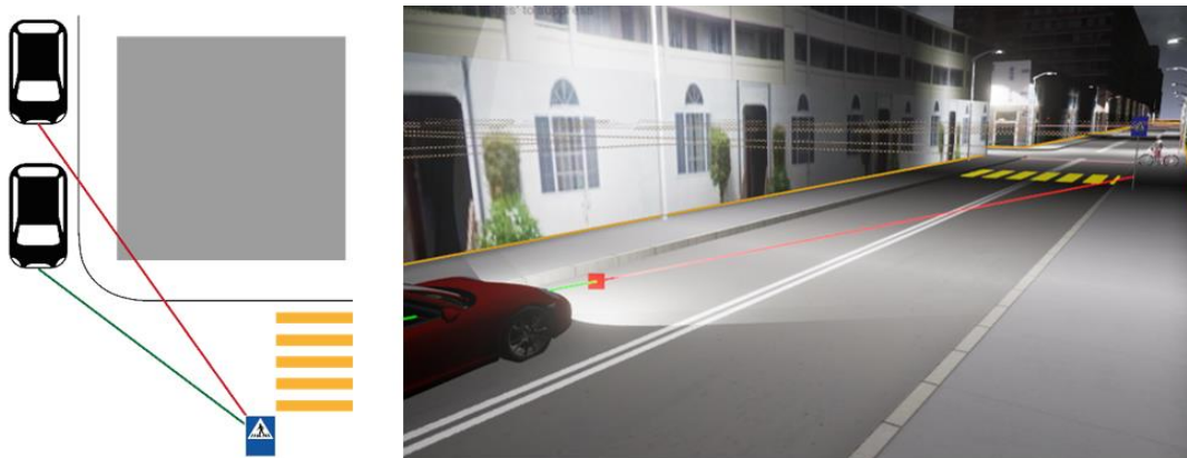
Abbildung 8: Referenzpunkterfassung durch Raycasting. Theorie (links) und Praxis (rechts) (eigene Darstellung)
