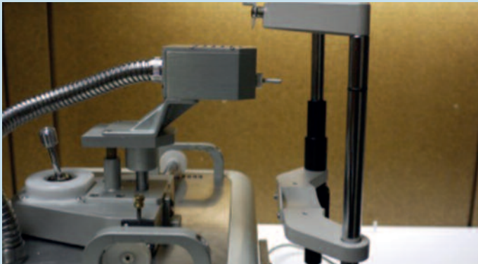
Abb. 10: Der Belmonte Luftstoß-Aesthesiometer („Belmonte Ocular Pain Meter“, OPM).
