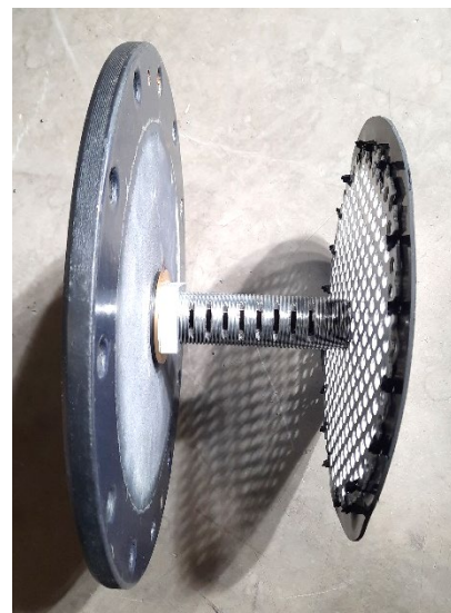
Abbildung 8: Vorrichtung im umgebauten Flansch des Boilers zur Beruhigung der Eintrittsströmung. Die Vorrichtung besteht aus einem geschlitztem Rohrstück, aus dem das Wasser in das Volumen des Wartungsflanschs eintritt, und einem Lochblech mit Gummidichtung, welches die Strömung weiter beruhigen soll, bevor sie in den Speicher eintritt.
