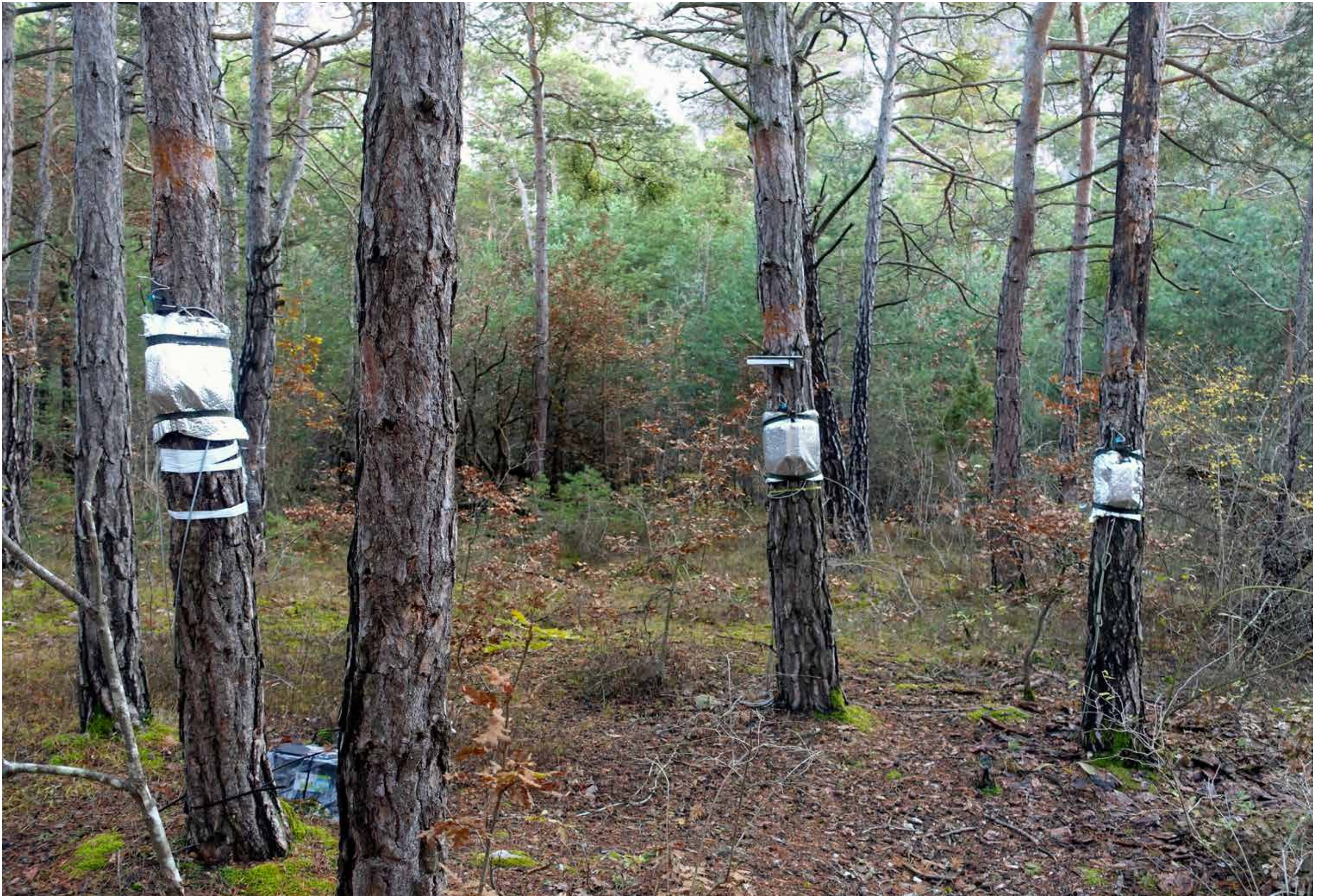
Forschungsplattform Pfywald. Das Wachstum und das Funktionieren der Föhren wird mittels verschiedener Sensoren im Minutentakt untersucht, zum Beispiel Jahrringwachstum, Saftfluss, Bodenfeuchtigkeit, -temperatur, -atmung, Photosyntheseleistung, Blattatmung, Streufall etc. Bild: Andreas Rigling, WSL Birmensdorf/Schweiz
