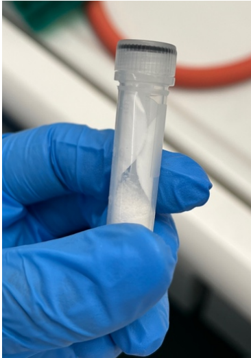
Abbildung 5: 25 mm Nitrocellulose Membran Filter (0.22 \mu\text{m} Triton-free MCE) nach Vakuum Filtration in die ZR BashingBead Lysis Tubes (0.1 & 0.5 mm) mit oberen Seite nach innen platziert.
