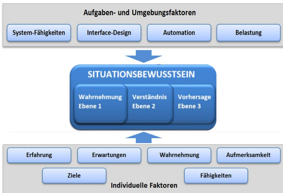
Abbildung 12. Ansatzpunkte für die Unterstützung der Situation Awareness (eigene Abbildung, nach Endsley, 1995)
