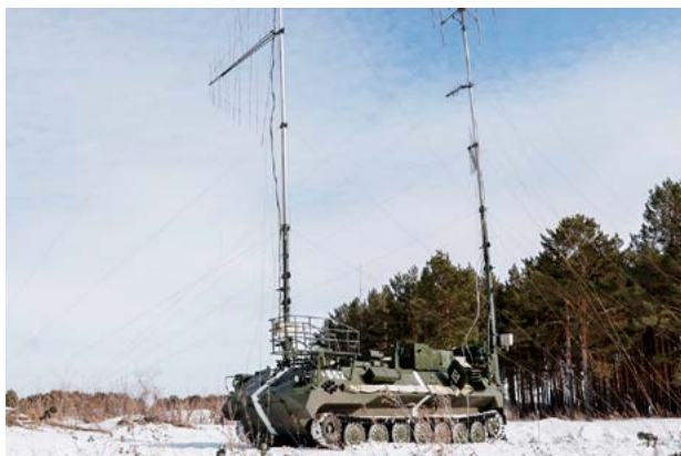
Abbildung 8 Informationskriegsführung besteht nach russischem Verständnis aus einer psychologischen und technischen Komponente. Die russischen Streitkräfte verfügen über umfangreiche Kräfte zur elektronischen Kriegsführung, für Cyberoperationen und psychologische Kriegsführung. Auf dem Bild das Störsender-System Borisoglebsk-2. (mil.ru, https://upload.wikimedia.org/wikipedia/commons/4/4c/ElectronicWarfareExercise2018-01.jpg )
