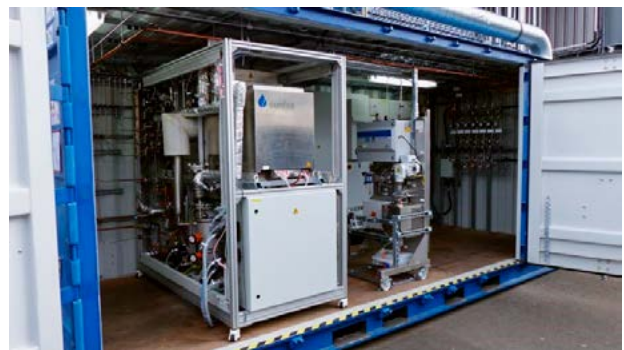
Abbildung 10 Prototyp der CO-Elektrolyse (10 kW DC): Hier wird überschüssige Sonnen- und Windenergie zur Synthese von Wasser und CO 2 zu synthetischem Benzin verwendet (Power to X), mit einem energetischen Wirkungsgrad von 80%. (Sunfire, DEU)
