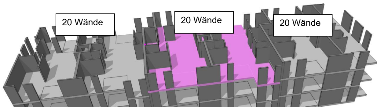
Abbildung 47 Beispiel eines Geschossmodells mit 20 Wänden pro Etappe
