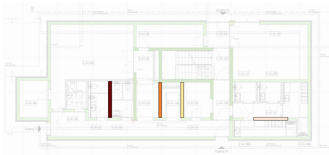
Abbildung 45 Auswahlmöglichkeit der als nächst zu bauenden Wände. Von links nach rechts: Rot, Orange, Gelb, Rosa.
