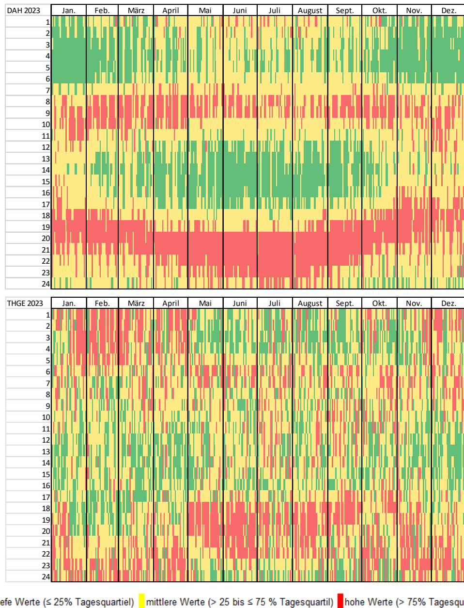
Abb. 11 Stündliche Einteilung der Day-Ahead Preise (oben) und Treibhausgasemissionen der in der Schweiz verfügbaren Elektrizität (unten) in die drei täglichen Wertebereichen: tief (grün), mittel (gelb) und hoch (rot) für das Jahr 2023.
