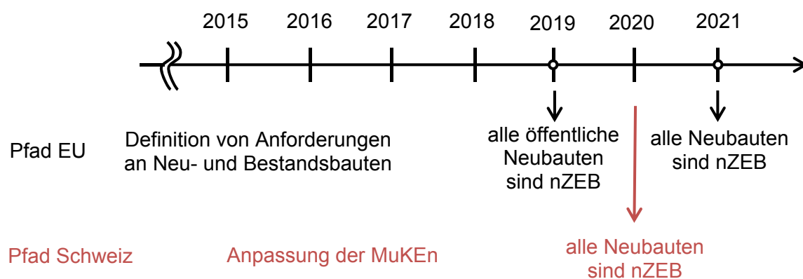
Bild 1 Zeitrahmen zur Einführung von Niedrigstenergiegebäuden (nearly zero energy buildings, nZEB) für Neubauten in der EU und in der Schweiz. Anforderungen an Bestandsbauten werden ebenfalls entwickelt.
