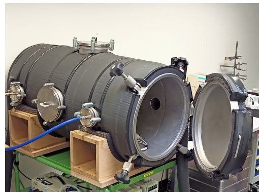
(b) Bild der geöffneten isolierten Radonkammer.
