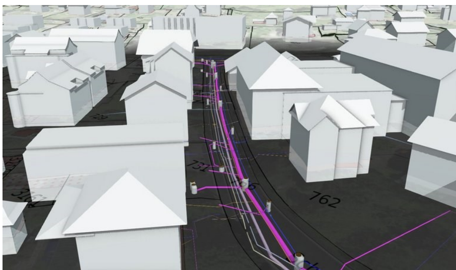
Abbildung 56: Leitungskataster in LUUCY (ds digital survey AG, 2022)
