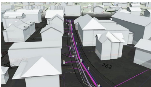
Abbildung 5. Leitungskataster in LUUCY (ds digital survey AG, 2022).
