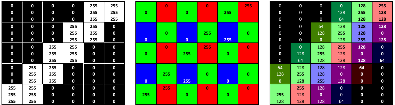
Abbildung 4: Entstehung eines Farbmoirés durch lineare Interpolation (Durchschnitt der 2 resp. 4 gleichfarbigen Nachbarpixel)
