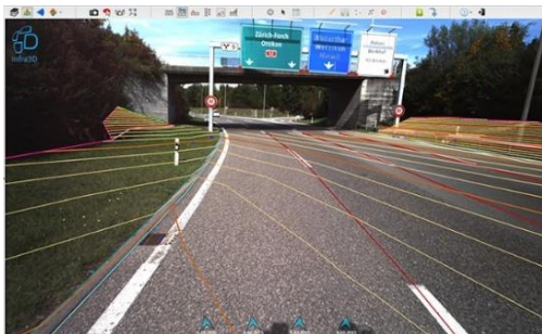
Abbildung 28: Erfassung und Kontrolle von Grundlagedaten und DHM für die Projektierung (Basler & Hofmann AG)
