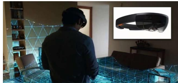
Abbildung 16: MicroSoft HoloLens mit triangulierter Tiefeninformation (Quelle: https://www.slideshare.net/AugmentedWorldExpo/aaron-pulkka-awe-eu16aaronpulkka )
