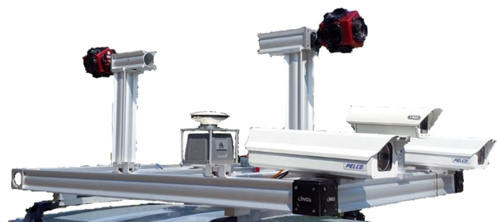
Abbildung 5: 360° Stereo-Panoramakamerasystem der FHNW mit horizontalen Stereobasen (Blaser et al., 2017)
