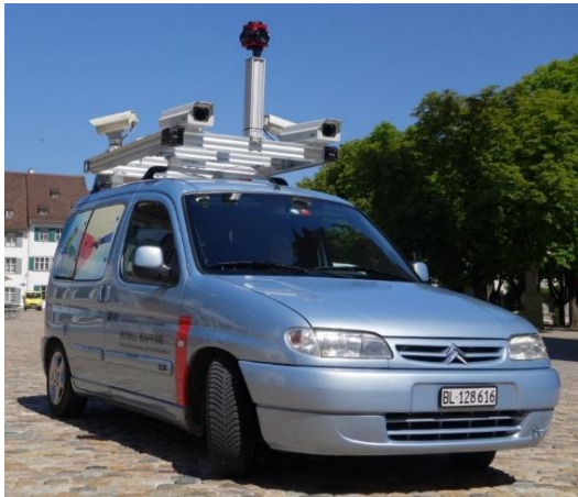
Abbildung 13: Forschungsfahrzeug des IVGI der FHNW mit drei Stereo-Kamerasystemen und einem monoskopischen Panorama-Kamerasystem
