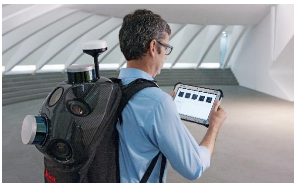
Abbildung 6: Leica Pegasus-Backpack mit fünf Bildsensoren und zwei Multi-Beam-LiDAR-Sensoren (Velodyne VLP16)
