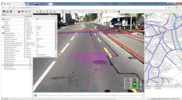
Abbildung 32: Leitungskataster – Augmentierung / Visualisierung und Kontrolle von Leitungskatasterdaten sowie Möglichkeit zur 3D-Attributierung der Oberflächenelemente
