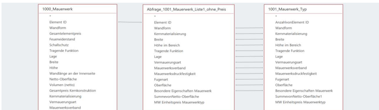
Abbildung 65: Entwurfsansicht der Tabelle aus Abbildung 64 mit Verbindung gleicher Attribute, Quelle: Eigene Grafik.
