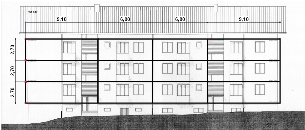
Abbildung 5: Mögliche Einteilung einer Fassade mit Grosselementen, die kleiner als 10m X 3.5m sind.
