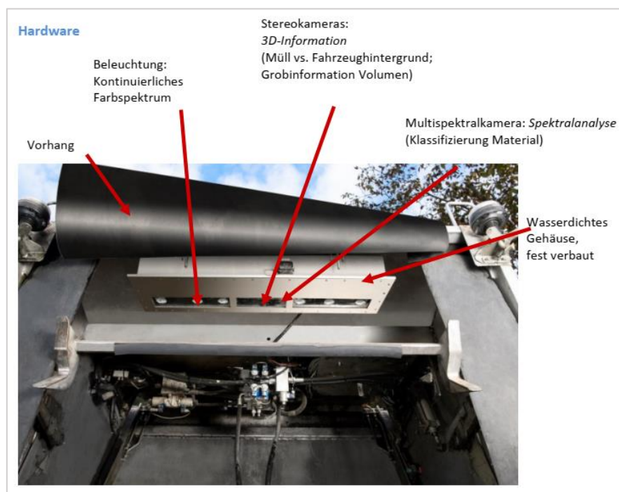
Abbildung 8: Aufnahmeeinheit in Sammelfahrzeug mit Gummivorhang, Quelle: Übernommen von [20].
