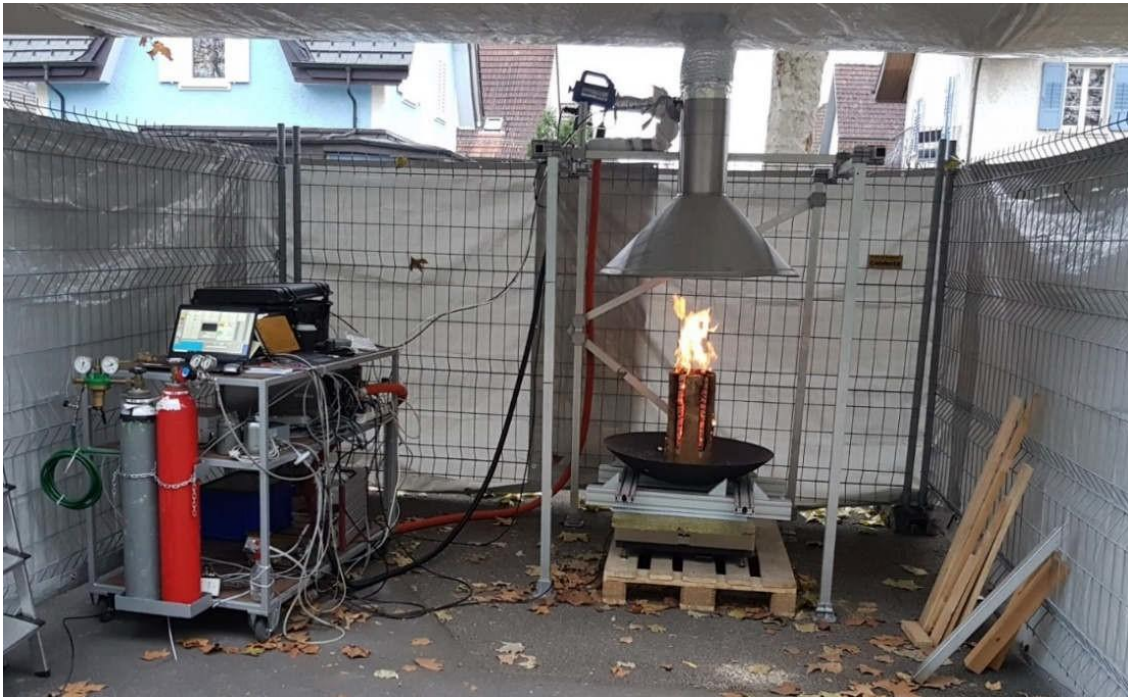
Abbildung 17: Versuchsaufbau Finnenkerze 3 (30min)
