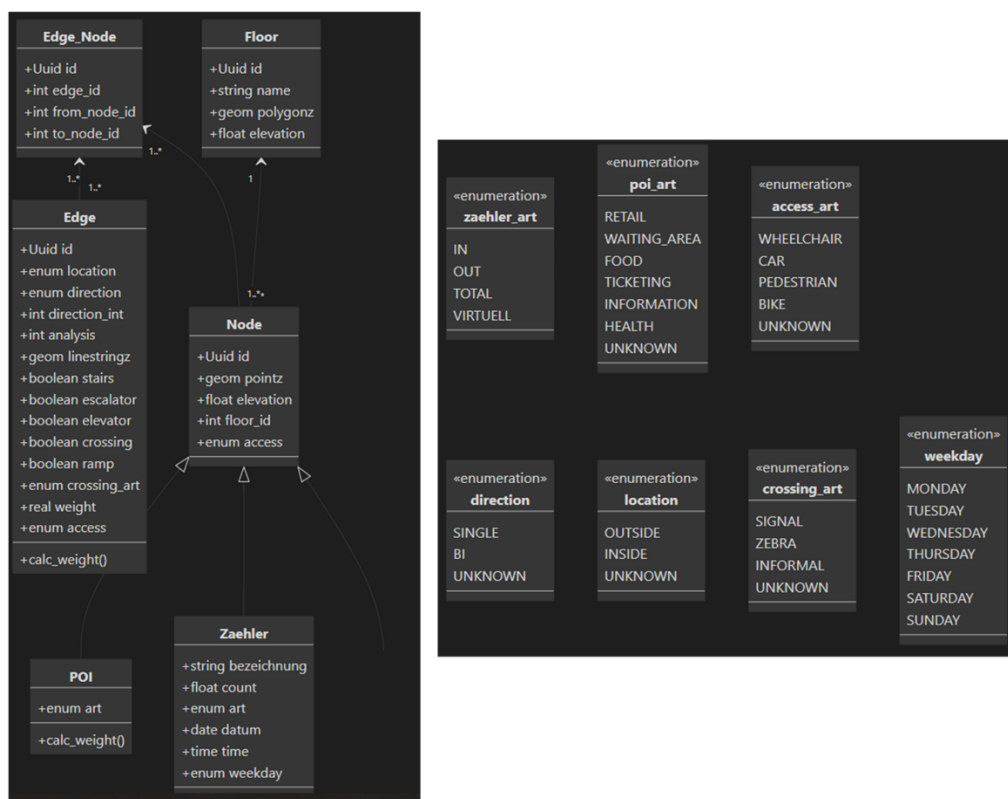
Abbildung 5 Klassendiagramm für das 3D-Netzwerk
