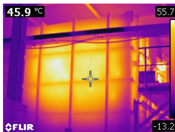
Abb. 2: Thermografische Falschfarbenaufnahme eines beheizten Ofens (HSLU, 2022)
