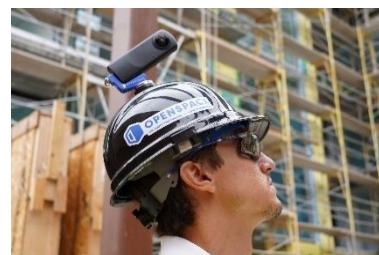
Abb. 47 360° Helmkamera zur Aufnahme der Baustelle (OpenSpace, 2024)
