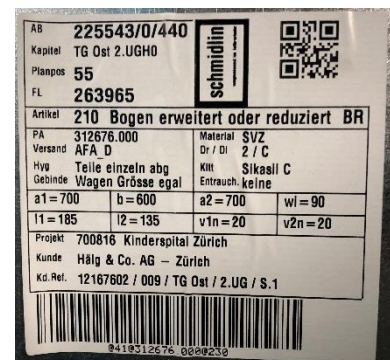
Abb. 58 Label eines Lüftungskanals mit QR-Code (Sven Schmucki, 2023)
