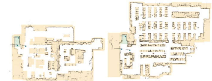
Abbildung 4: Online-Grafikkarte auf dem AMR, links das EG, rechts das UG. Hellbraun die ausgeschlossenen Fahrbereiche, die hellgrünen Bereiche sind die Liftkabinen, die dunkelgrünen Punkte AMR Ziele im Lift und im Wartebereich
