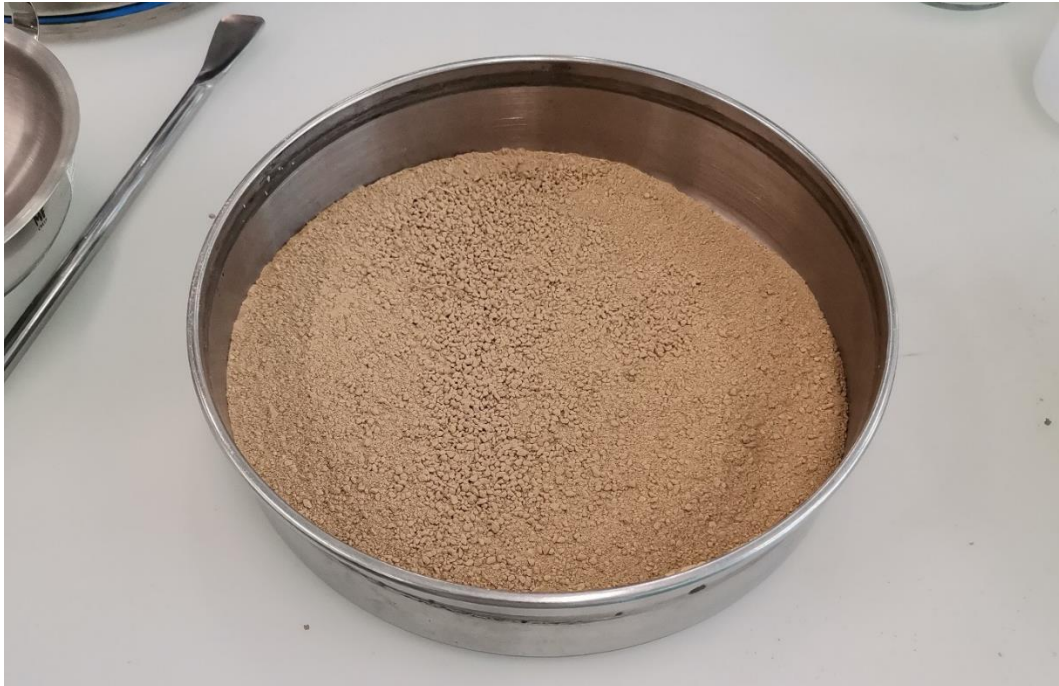
Abbildung 6: Fertig vorbereitete Bodenprobe nach dem Sieben
