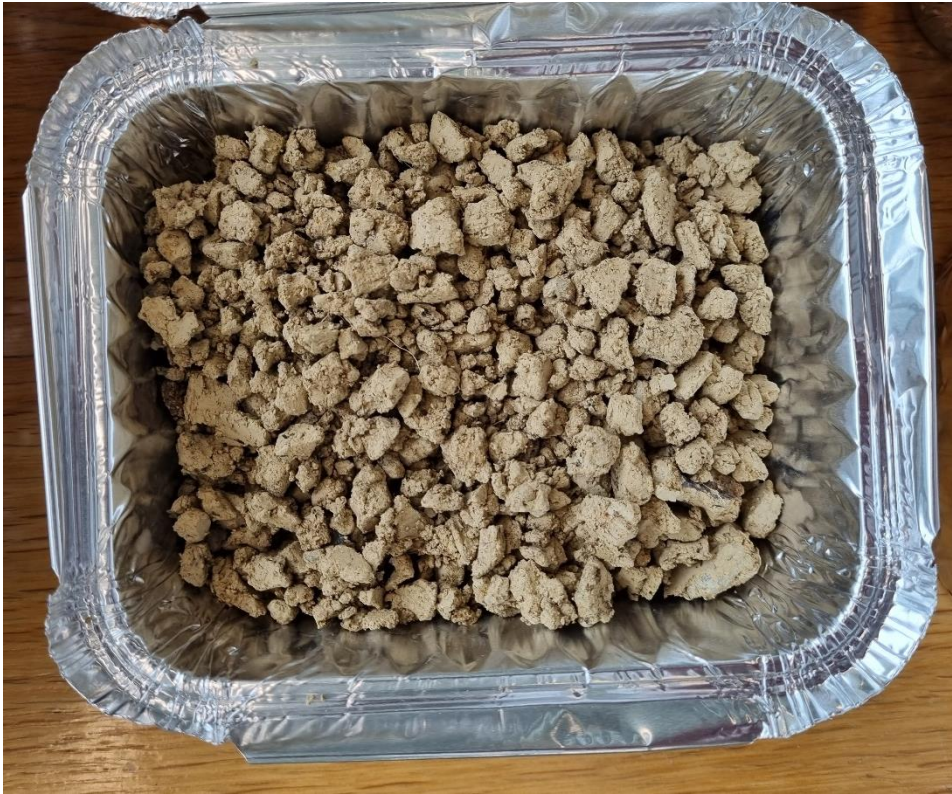
Abbildung 5: zerkleinerte und getrocknete Bodenprobe
