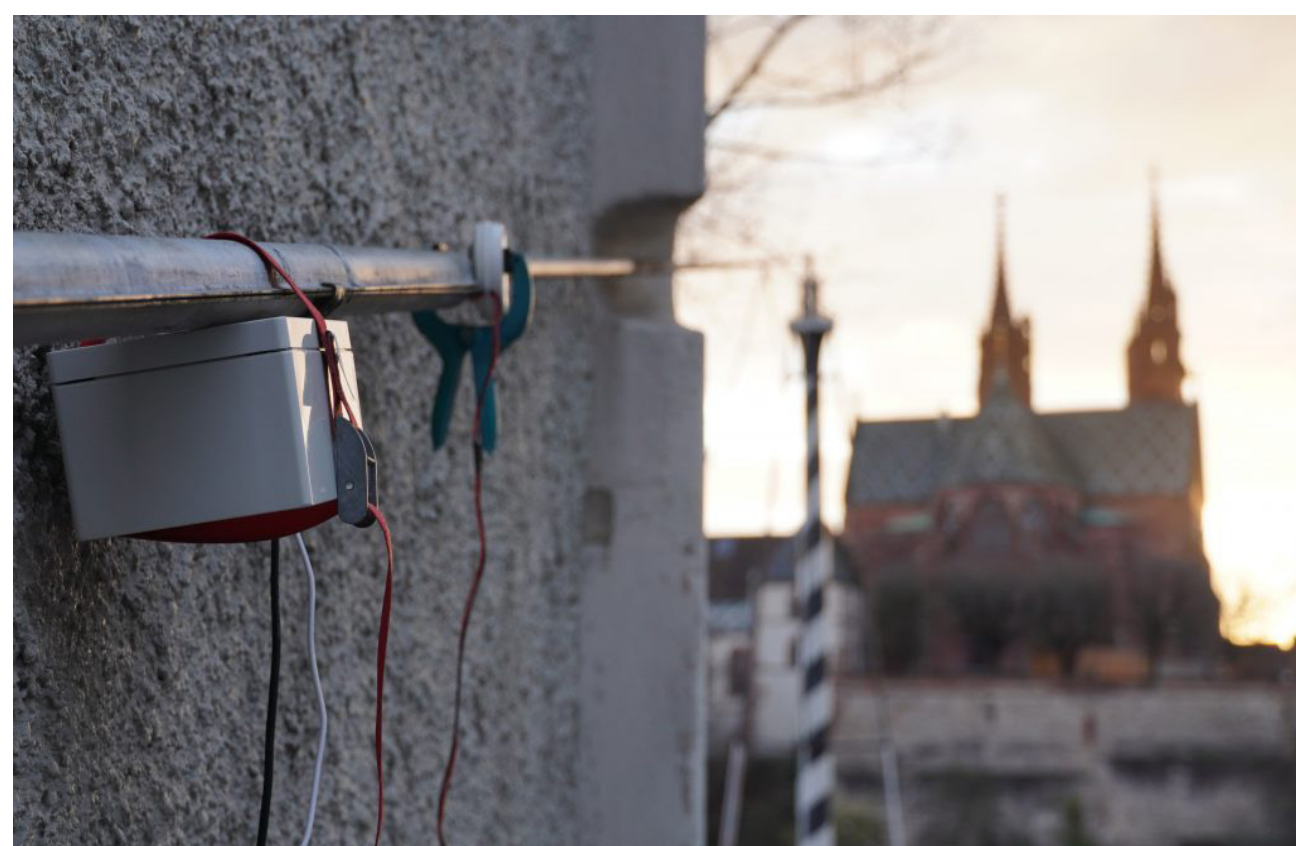
Der Seilsender, befestigt am Seil der Münsterfähre in Basel.
