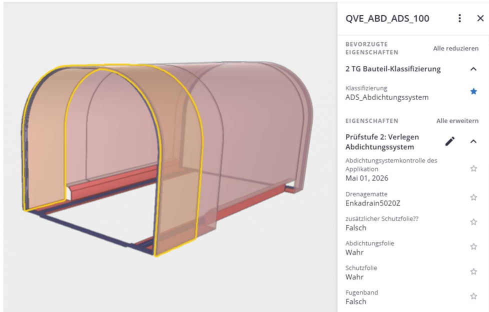
Abbildung 26, Zuweisung der neuen Properties an die Elemente des Modells (Screenshot des Testprojekts).
