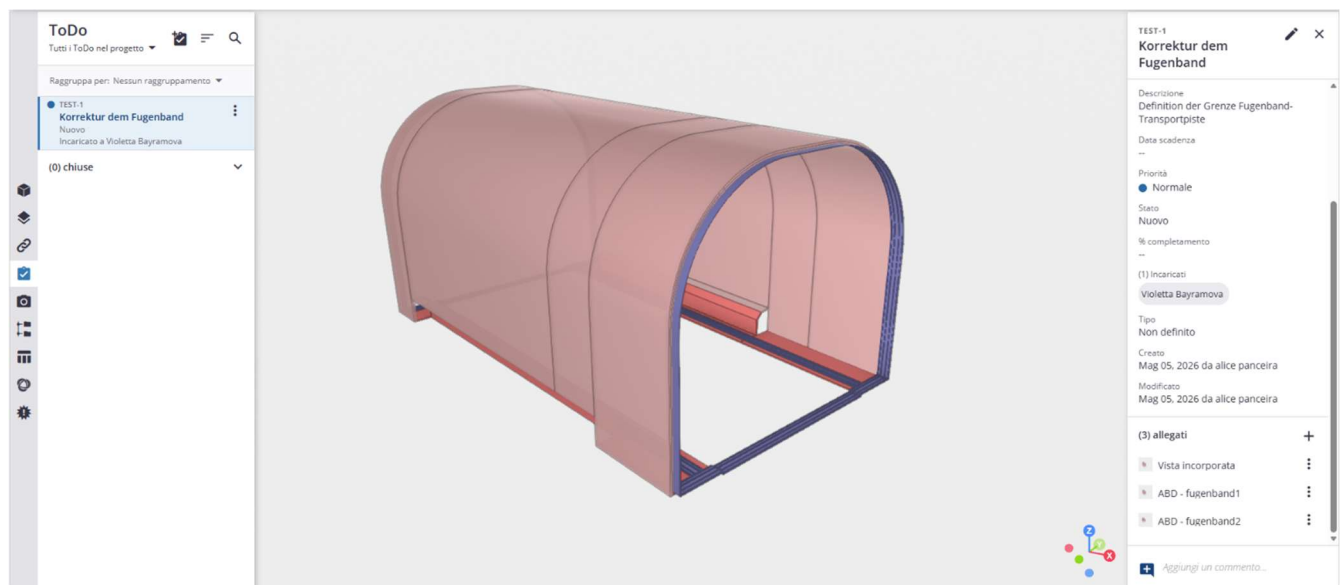
Abbildung 27, Beispielhafter ToDo-Eintrag „Korrektur dem Fugenband“ als Rückkanal von der Bauleitung an den Unternehmer; sichtbar sind Beschreibung, Zuweisung und beigefügte Modellausschnitte (Screenshot des Testprojekts).
