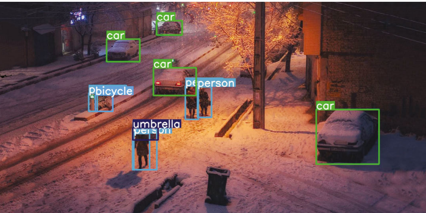
Abbildung 1: Zeigt die Auswertung einer Objekt- bzw. Personenerkennung mittels Kamerabild. Trotz «Erschwernissen» wie Schnee und Dunkelheit ist diese Objekterkennungs-Software in der Lage, Menschen und verschiedene Objekte zu erkennen und zu lokalisieren.
