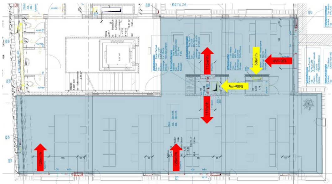
Abbildung 15. Übersicht über die Zu- und Abluftöffnungen im der Raumgruppe «Grossraumbüro».
