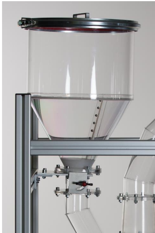
Abbildung 19: Eigenes Bild des Behälters für das Aufgabegut sowie der Dosiervorrichtung
