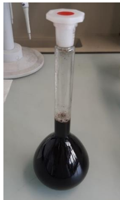
Abbildung 22: Probe mit aufgelöstem Karbonisat im Messkolben
