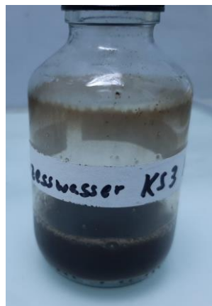
Abbildung 43: Ablagerungen an der Innenseite des Prozesswasser-Probefläschchens
