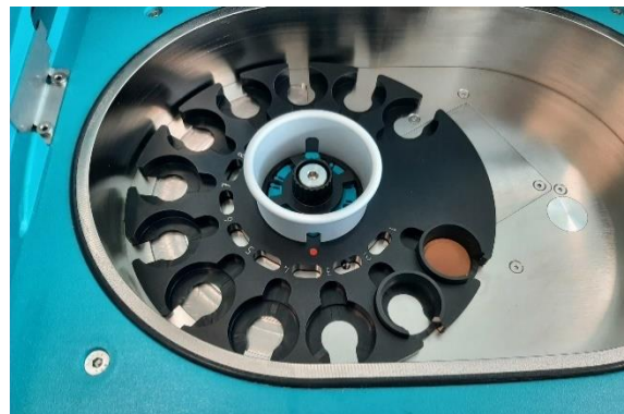
Abbildung 29: Pressling im Röntgenfluoreszenz-Spektrometer Xepos von Spectro
