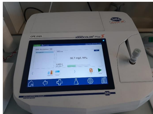
Abbildung 34: Photometer von Macherey Nagel (hier bei der Analyse einer Ammonium-Rundküvette)
