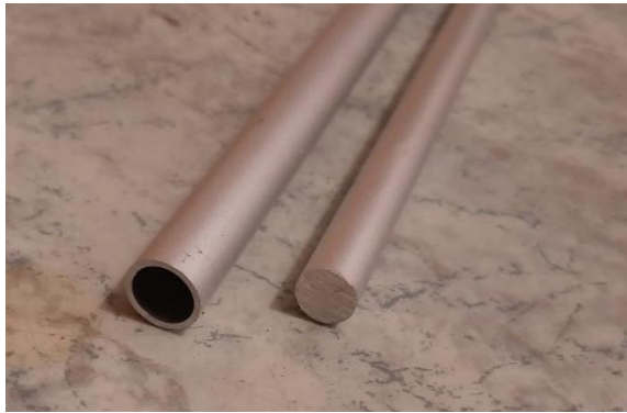
Abbildung 16: Aluminiumrohr und -stange zum Pelletieren des Karbonisats
