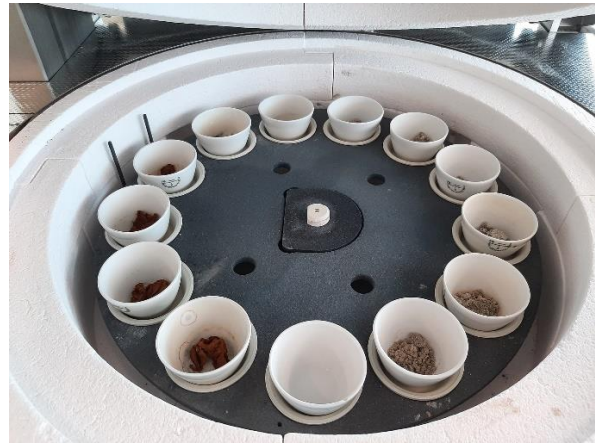
Abbildung 24: Innenraum des VeraschungsOfens mit roten Aschen aus Klärschlamm-Proben links und gräulichen Aschen aus Gülle-Proben rechts
