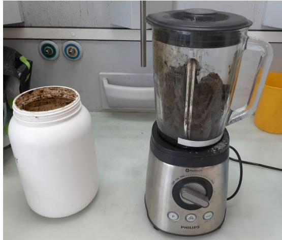
Abbildung 10: Fehlgeschlagener Versuch, die aufkonzentrierte Gülle mittels Küchenmixer zu verfeinern
