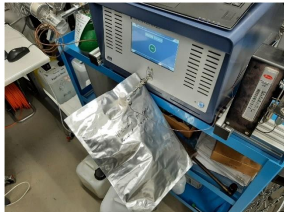
Abbildung 38: An den Micro Gas Chromatograph angeschlossener Gas Sampling Bag
