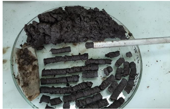
Abbildung 17: Pelletieren mithilfe eines 8 mm Aluminiumrohres
