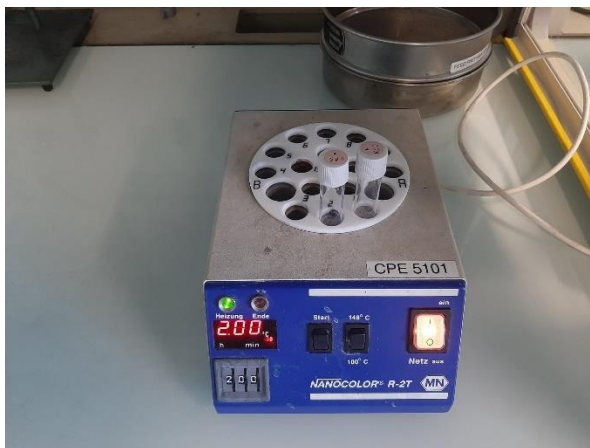
Abbildung 33: Heizblock mit zwei Rundküvetten, in welchen stickstoffhaltige Substanzen zu Nitrat oxidiert werden
