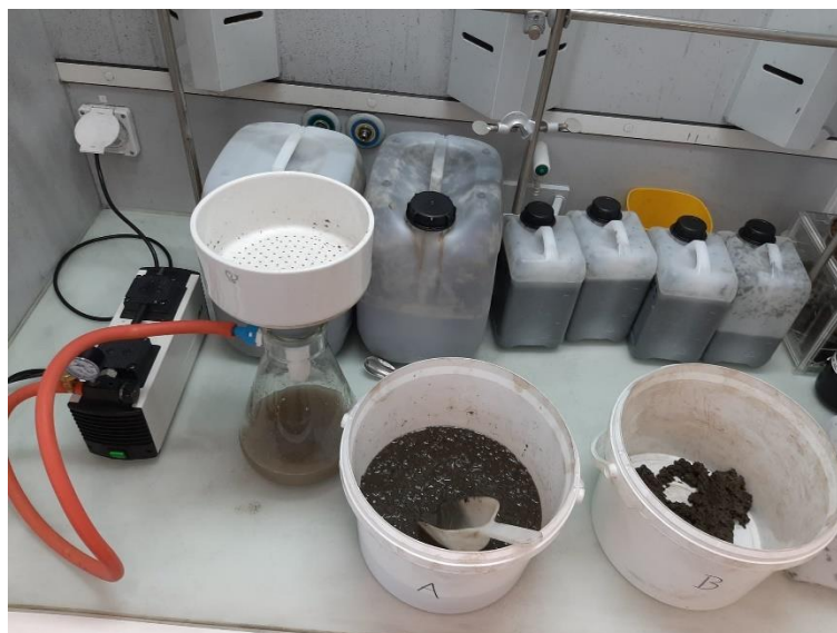
Abbildung 6: Installation zum Filtrieren des Klärschlammes bestehend aus einer Nutsche, Saugflasche und Vakuumpumpe
