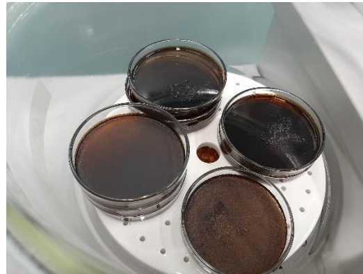
Abbildung 19: Getrocknetes Prozesswasser im Exsikkator
