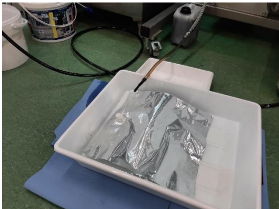
Abbildung 37: Befüllung eines Gas Sampling Bags mit Prozessgas
