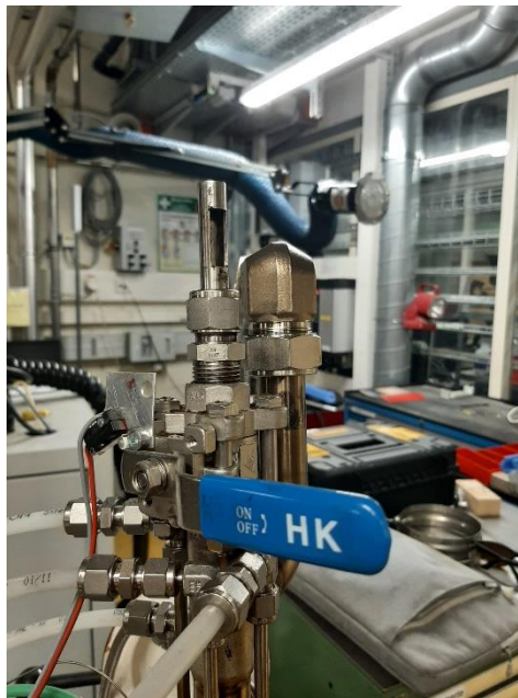
Abbildung 41: Vorrichtung zum Zugeben von Pellets in den Einzelpelletofen
