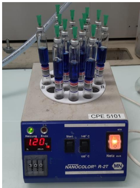
Abbildung 32: TOC-Rundküvetten mit eingestochenen Druckausgleichs-Kanülen
