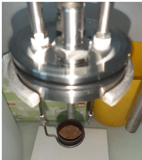
Abbildung 26: Deckel des Bombenkalorimeters mit Tiegel und Zünddraht durch eine Karbonisat-Probe
