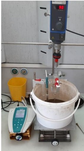
Abbildung 20: Messaufbau für den pH-Wert des Feeds
