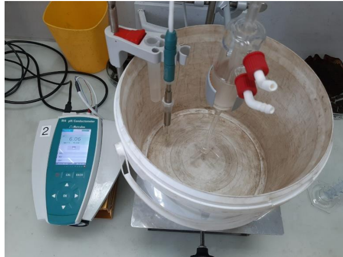
Abbildung 21: Nahansicht der pH-Sonde und dem Rührer
