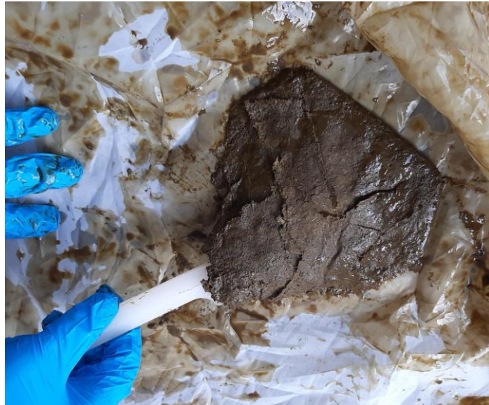
Abbildung 8: Mit der Obstpresse entwässerter Gülle-Filterkuchen
