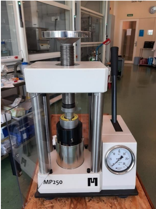
Abbildung 27: Laborpresse MP250 von Maassen
