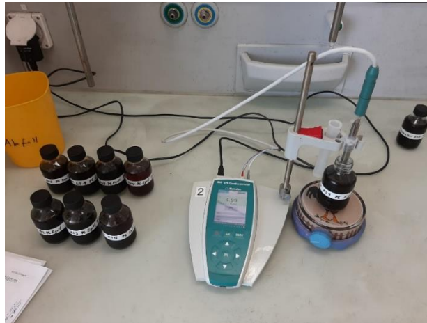
Abbildung 30: Bestimmung des pH-Werts des Prozesswassers
