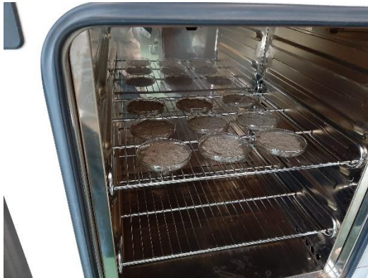
Abbildung 18: Getrocknete Klärschlammproben im Trockenschrank
