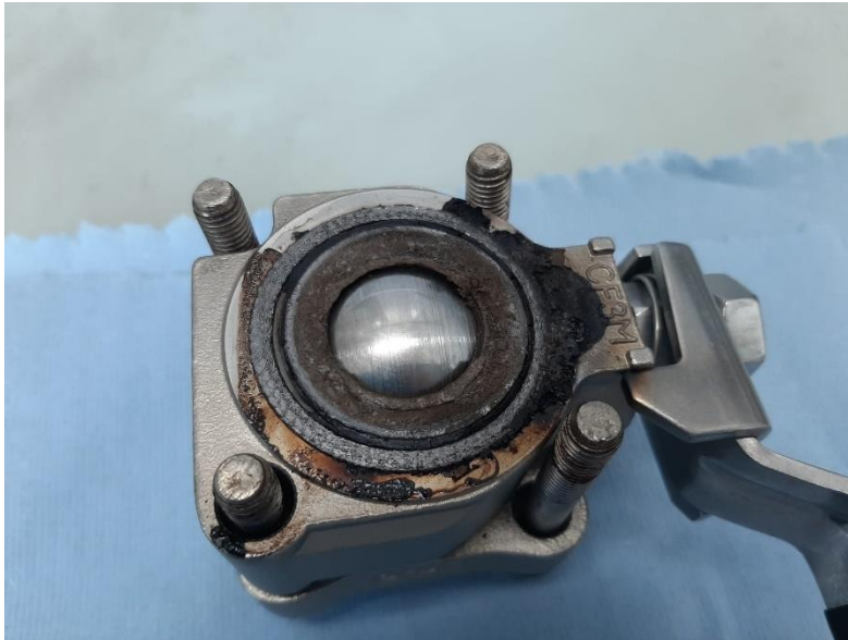
Abbildung 12: Nach der Versuchsserie abmontierter Kugelhahn (Bodenauslass) mit Verschmutzungen
