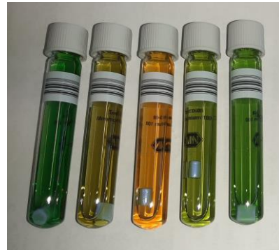
Abbildung 36: Rundküvetten kurz nach der photometrischen/ kolorimetrischen Messung
