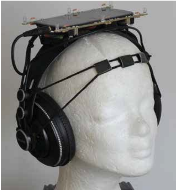
Abbildung 2: Head Mounted Device: Auf dem Bügel zwischen den Ohrmuscheln sind ein Smartphone und sechs Infrarot-LEDs angebracht. Der Kopfhörer ist ans Smartphone angeschlossen.
