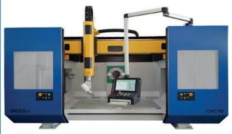
Die neue Baureihe zum Beschnitt von Kunststoffteilen bis hin zur Herstellung von Formen aus Aluminium für technische Kunststoffteile.
